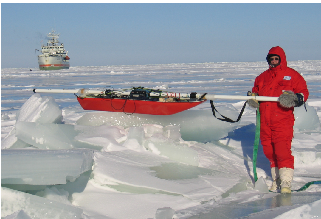
Abbildung 2: Die Messung mit dem Sensor „Geonics EM31“ Quelle: www.awi-bremerhaven.de
