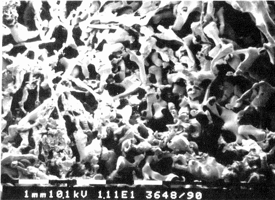
Bild 1: REM-Aufnahme eines Eisausgusses von körnigem Eis (T = -2,5 °C).
