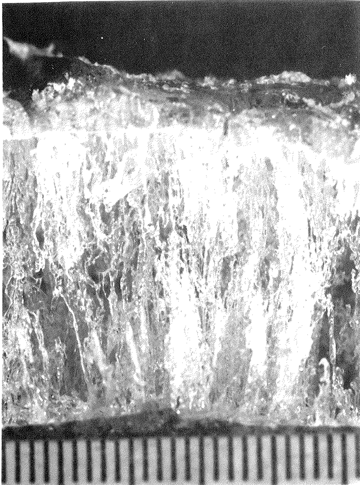
Bild 5: Lichtoptische Aufnahme eines Eisausgusses von säuligem Eis im Längsschnitt.
