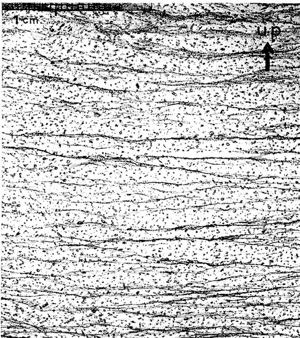
Abb. 5: Vertikaler Dünnschliff vom Milcent Kern aus 250 m Tiefe. Die leicht gekrümmten Linien sind Risse im Eis. Die Skala ist oben links angegeben.
