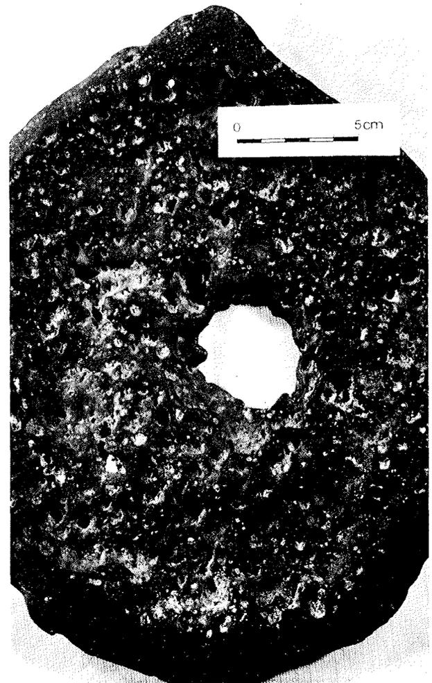
Bild 2: Probe vom Helgoländer Kupfererz: Die Probe wurde an der Nordspitze der Insel, etwa in der Nähe der Langen Anna, entnommen. Im Bild lassen die dunkleren Bereiche die Cuprit-Vererzung (Cu<sub>2</sub>O) gut erkennen.
