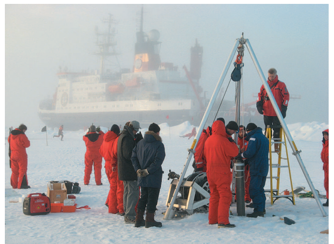
Abb. 3: Ein internationales Team beim Ausbringen einer Eisboje. Die von der Boje getragene Sonde misst jeden Tag ein Profil der Temperatur und des Salzgehalts bis in 800 m Tiefe und sendet die Daten per Satellit an Land (Foto: K. Bakker, NIOZ).
