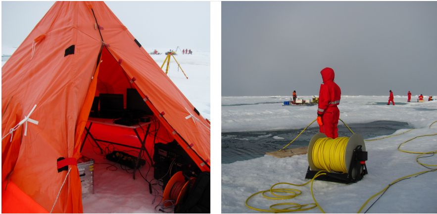
Abbildung 3.2: Links: Zelt mit Mess- und Steuerelektronik, Referenzsensor auf gelbem Stativ im Hintergrund; Rechts: Eine Person am Zugangsloch überwacht die ausgegebene Kabellänge. Beide Fotos wurden während der Station am 17. August aufgenommen.
