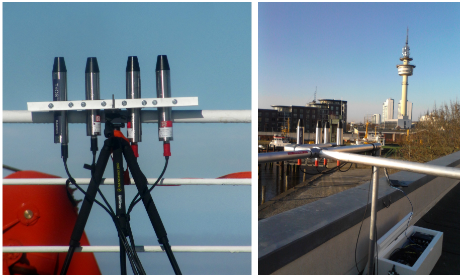
Abbildung 3.8: Verwendete RAMSES-Sensoren während der Nachkalibrierung auf dem Peildeck an Bord FS POLARSTERN (links) und auf dem Dach des Institutsgebäudes in Bremerhaven (rechts)
