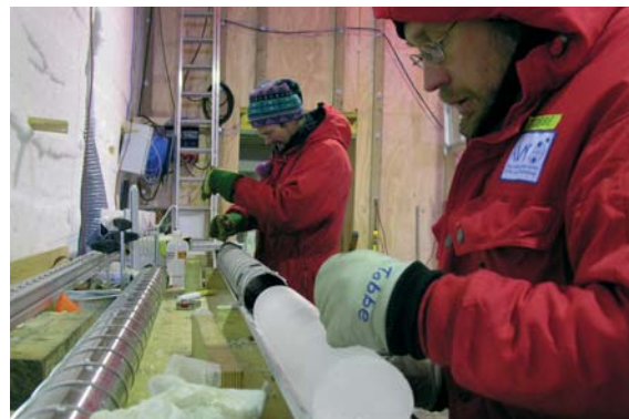
Abb. 3: Ein frisch gewonnener Eiskern wird gesäubert, bevor er der weiteren Verarbeitung zugeführt wird.
