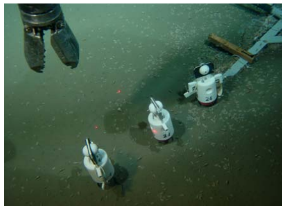
Abb. 3: Mit den abgebildeten Stechrohren werden Sedimentproben im unmittelbaren Umfeld des Walkadavers gezogen, um die Auswirkungen eines derartigen Nahrungseintrags auf sedimentbewohnende Organismen später im Labor analysieren zu können. Auf der Sedimentoberfläche sind massenhaft Flohkrebse, Asseln und Seegurken zu erkennen.
