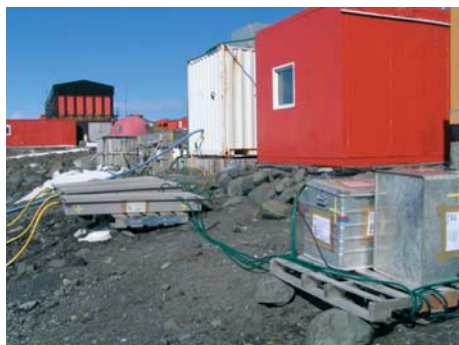
Abb. 3: Versuchsaufbau zur Untersuchung interaktiver Strahlungs- und Temperatureffekte auf die Photosynthese mariner Makroalgen am Dallmann-Labor (Jubany Station, King-George-Island, Antarktis). In den grauen Wannen im Hintergrund werden Makroalgen der natürlichen Sonnenstrahlung ausgesetzt. Die Wassertemperatur in den Wannen wird über Kryostate kontrolliert, welche in Zarges-Boxen vor Schnee und Regen geschützt sind (Bildvordergrund) (Foto: Ralf Rautenberger, IPÖ Kiel).
