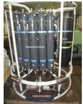
Abb. 2: CTD-Wasserschöpferrosette mit Kamerasystem und Krill-Lichtfalle, (Rob King).
