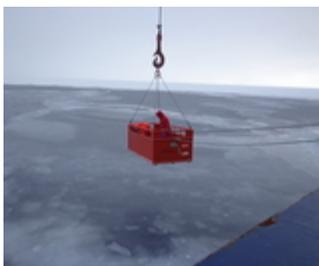
Abb. 2a: Auf dem Weg zur Frostblumen-Ernte mit dem myrmecochore Chair (eine Stahlgondel), mit dem Ausleger des Kranes über das Eis geschwenkt werden kann (Foto Gernot Nehrke).
