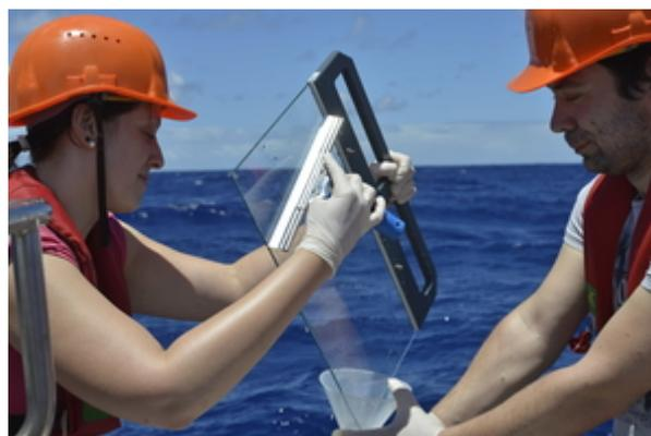
Abbildung 3: Probenahme des Oberflächenfilms vom Schlauchboot aus. © Hartwig Deneke, TROPOS.
