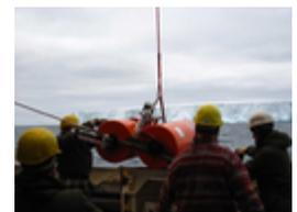
Eines der Ozeanbodenseismometer (OBS) ist vom Meeresboden zurück an die Oberfläche gekommen und wird an Deck gehoben. (Foto: K. Gohl)
