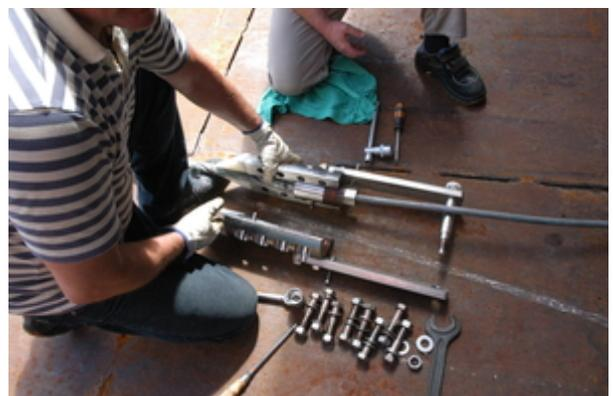
Die neue Kabelterminierung in zerlegtem Zustand. (Foto: Saad El Naggari)
