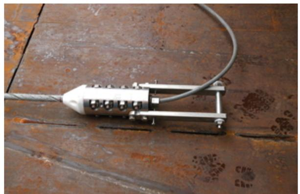
Die neue Kabelterminierung in zusammengebautem Zustand. (Foto: E. Dunker)
