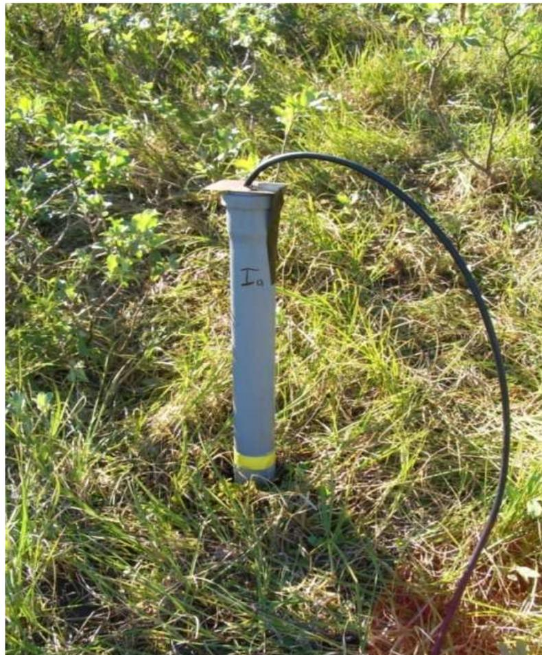
**Abbildung 9: Darstellung einer Suprapermafrostwasser-Messstelle, Drucksensoren messen den Wasserspiegel**
