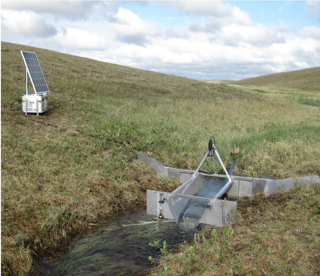
**Abbildung 11: Darstellung des Wehres mit fest installiertem Radar-Höhensensor;
