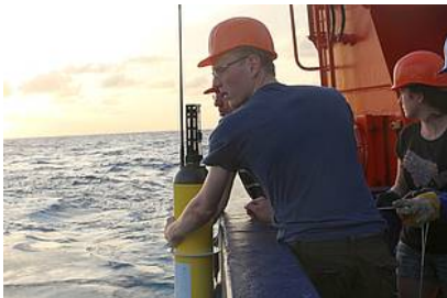
Abb. 2: Aussetzen eines ARGO-Floats (Foto: Tobias Küchler, TROPOS)
