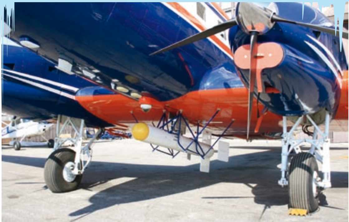
Abb 1: Schleppsonde zur Bestimmung der Dicke von Meereis am Rumpf des Polarforschungsflugzeugs „Polar 5“ in Fairbanks, Alaska Foto: Stefan Hendricks, AWI
