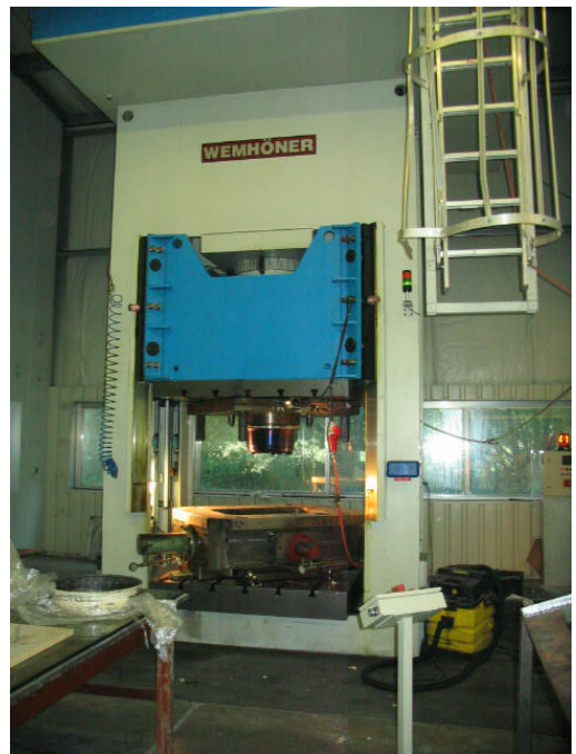
Abbildung 16: Hydraulische Presse zum Pressen der SMC-Matten
