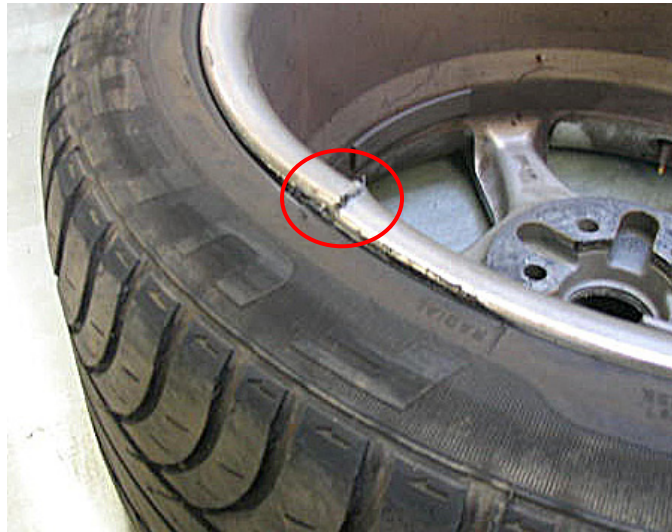
Abbildung 10: Riss (rot markiert) in der Felge nach dem Schwellentest
