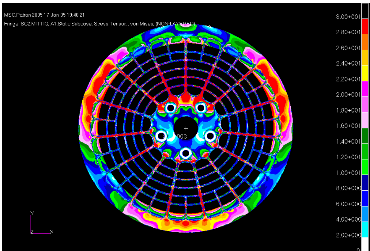
Abbildung 52: Frontansicht der Bionikfelge. Von Mises-Spannungen bis 30N/mm 2 für den Lastfall „Mitte“
