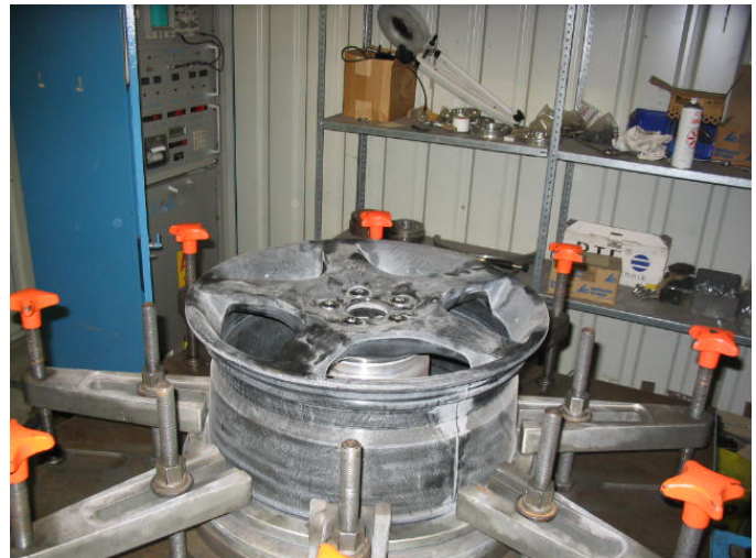
Abbildung 6: Fixiertes PKW-Rad auf dem BUP-Maschinentisch
