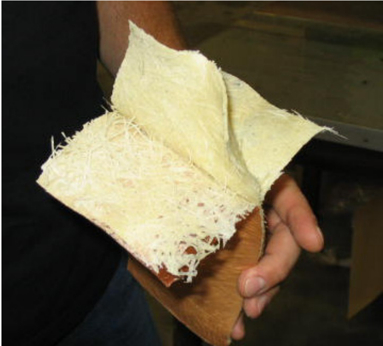
Abbildung 15: Ungerichteter Faserverlauf in einer auseinander genommenen Harzmatte
