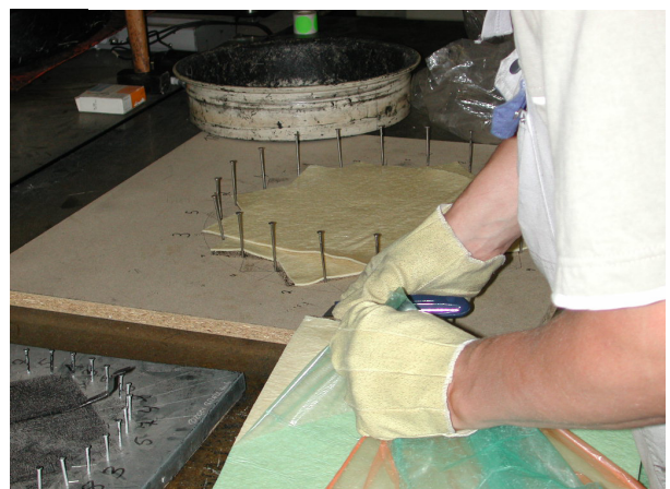
Abbildung 17: Zurechtschneiden und Legen der SMC-Matten
