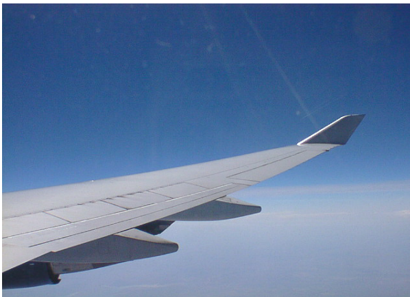
Abbildung 2: Winglet an der Spitze eines Flugzeugflügels [2]
