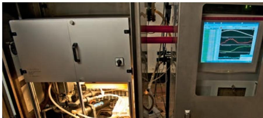
Vollgestopft mit Messsensoren liefert die FerryBox rund um die Uhr aktuelle Werte über eine Datenleitung direkt an den Arbeitsplatz. Foto: U. Nettelmann
