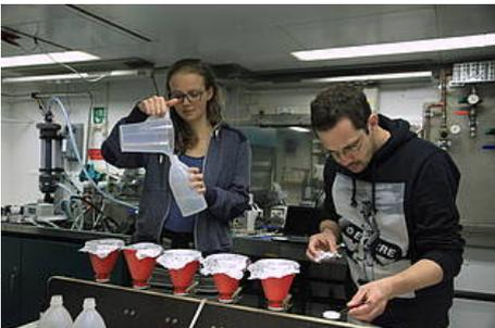
Abb. 2 (23. Jan. 17, 18:22): Meerwasserproben werden für spätere Analysen auf Glasfaserfiltern filtriert. (Foto: Tom Ehrhardt)
