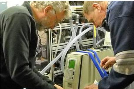
Abb. 1 (22. Dez. 16, 14:20): Kalibrierung des Systems  $\mu\text{MAC1000}$  Analysators (zur Verfügung gestellt von M. Gehrung, GKSS) zur Bestimmung von Ammonium im ozeanischen Oberflächenwasser. (Foto: Marion Kreilein)
