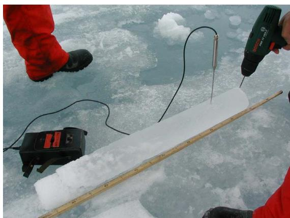
**Abbildung 3.10:** Temperaturmessungen an einem Eiskern
