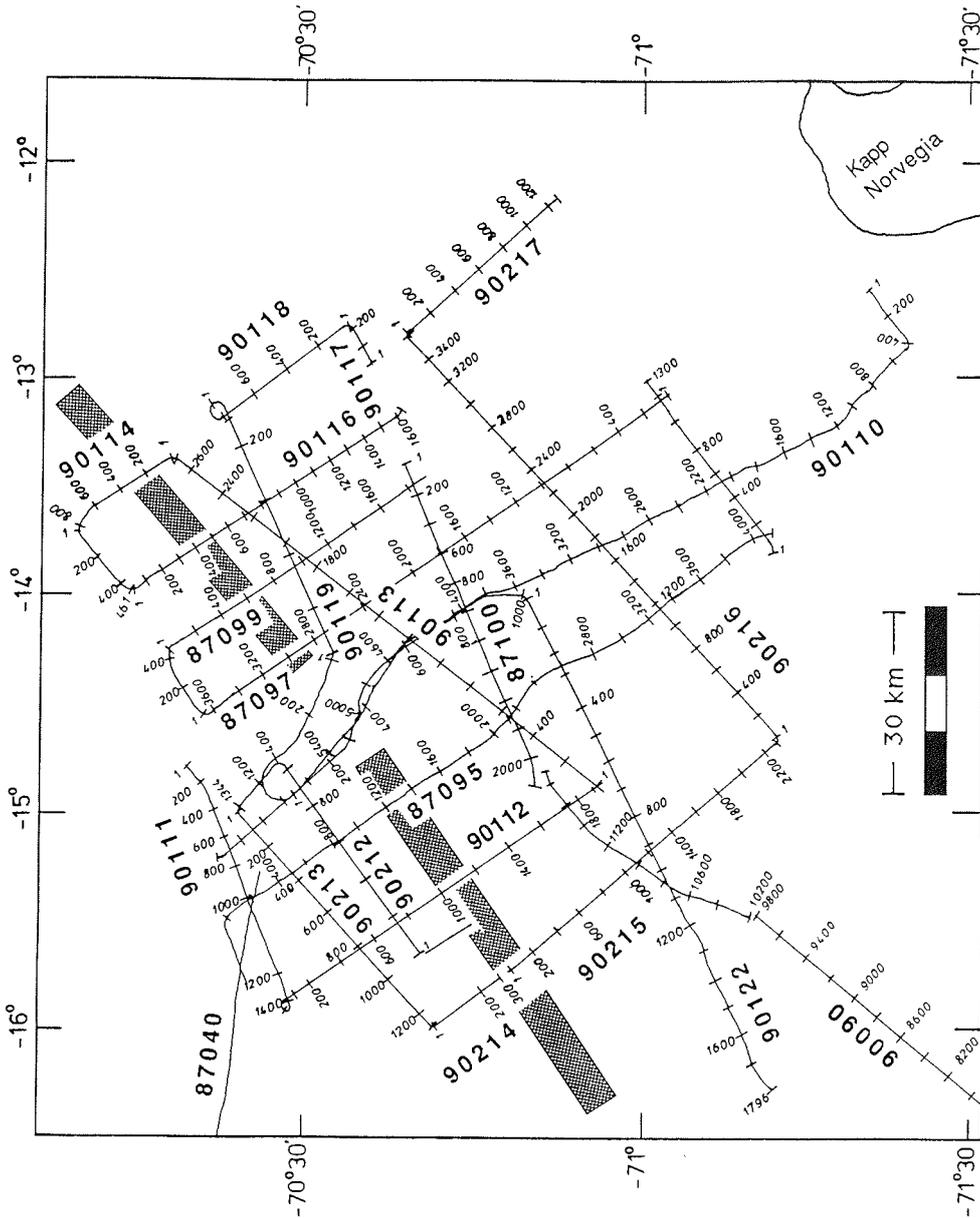
Abb. 4.2.1: Profilplan der reflexionsseismischen Linien der AWI Meßfahrten ANT V/4 und ANT VIII/5. Die kleineren Zahlen an den Profilen kennzeichnen die Schußpunktnummern. Das Kartengebiet hat eine Größe von 175 km (E-W) x 157 km (N-S). Das Explora Escarpment ist schraffiert gekennzeichnet.
