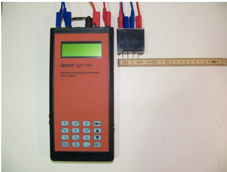
Abb. 3: Verwendetes Messgerät 4point light 10W der Firma L-GM mit miniaturisiertem Wenner-Array
