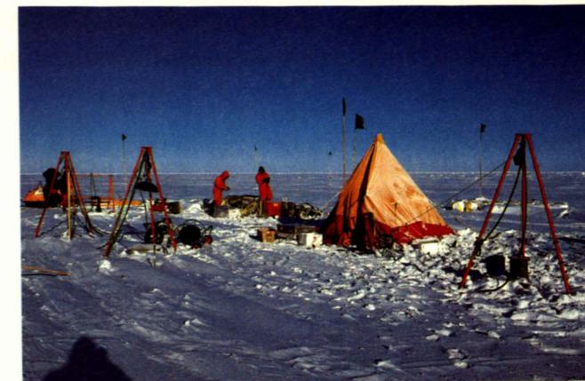
Abb. 2: Station auf dem Meereis zur Erfassung der turbulenten Wärme- und Impulsflüsse im Wasser unmittelbar unter dem Eis.
