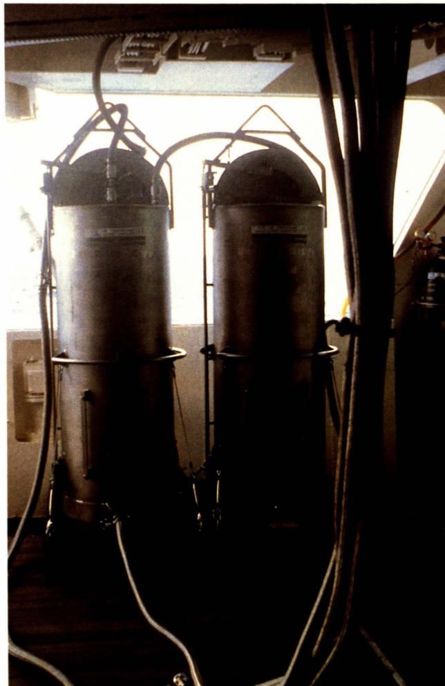
Abb. 1: Großraumwasserschöpfer zur Aufnahme von Tiefenwasser; geschöpftes Wasser wird in Edelstahlschläuchen zur Extraktionsanlage gepumpt.
