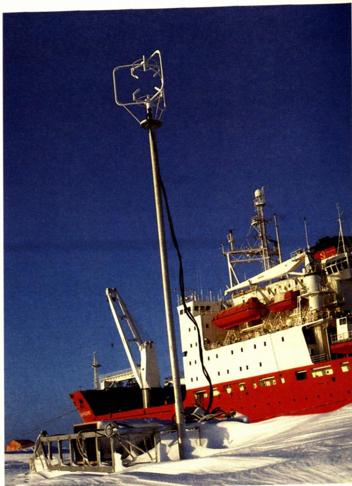
Abb. 1: Meßeinrichtungen auf dem Meereis zur Bestimmung der atmosphärischen Wärme- und Impulsflüsse.
