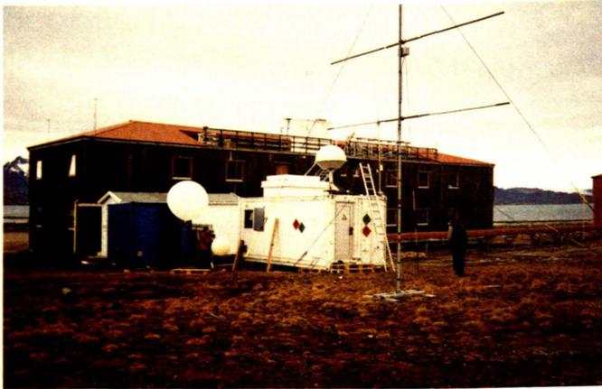
Abb. 3: Die Ozonmeßstation des AWI in Ny-Aalesund, Spitzbergen. Das LIDAR ist in dem weißen Labor-Container untergebracht. Auf dem Dach befinden sich die Empfangs-Antennen für die ballongetragenen Ozonsonden. Links wird ein Wetterballon gefüllt, im Hintergrund ein Gebäude der norwegischen Forschungsstation.
