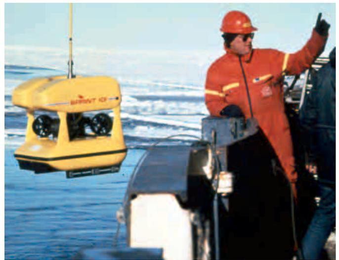
Abb. 13: Aussetzen eines über Kabel ferngesteuerten Unterwasser-Vehikels (SPRINT 101), genannt UWE auf FS „Polarstern“ 1986 (Foto: W. Hagen).
