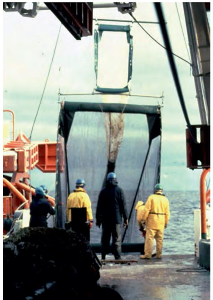
Abb. 11: Aussetzen des „Rectangular Midwater Trawl“ (RMT 8) auf FS „Polarstern“ 1983 zum Fang von Makrozooplankton und Mikronekton (Foto: U. Piatkowski).
