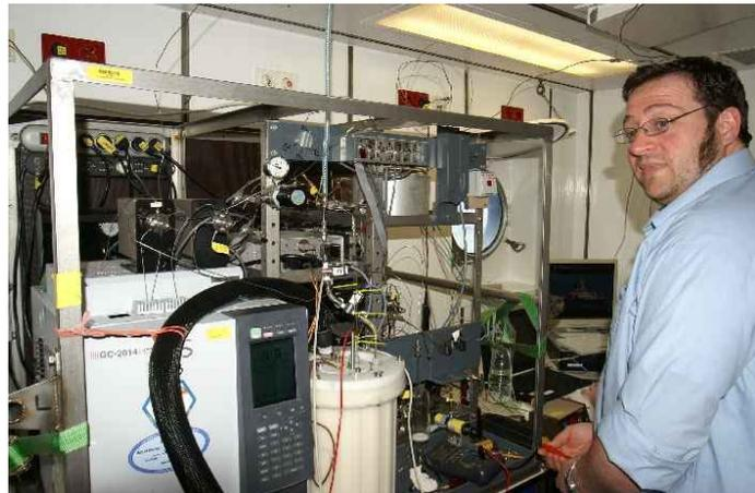
*Boie Bogner bedient das Instrument zur Bestimmung von SF<sub>6</sub> und FCKW-12 Konzentrationen in den Wasserproben.*
