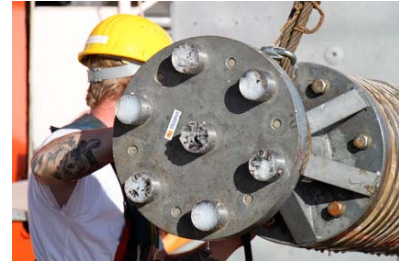
Einholen des Vulkanit-Stoßrohres. Die Gesteinssplitter (Basalt) an den Vaseline-gefüllten Stanzbechern kennzeichnen eine erfolgreiche Beprobung der Vulkanoberfläche (Foto: Thomas Ronge)
