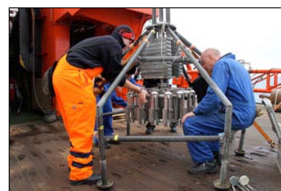
Montieren des Multicorers (MUC) zur Beprobung des Meeresbodens (Foto: Thomas Ronge)
