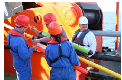
Montieren der Stabilisatoren am „Streamer“ (Foto: Thomas Ronge)
