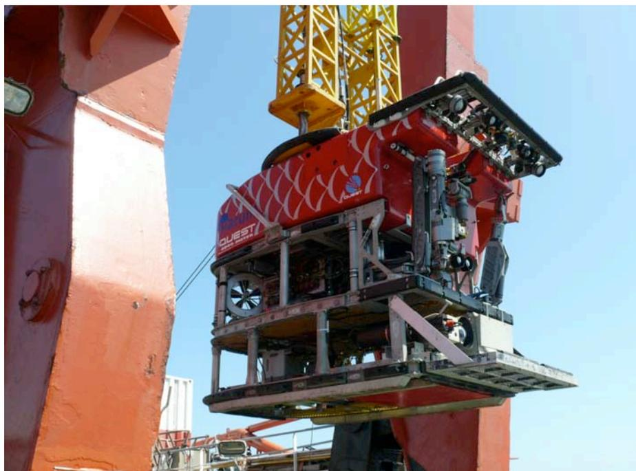
Der MARUM Tauchroboter QUEST beim Aussetzen zu seinem zweiten Tauchgang am KK#3.
