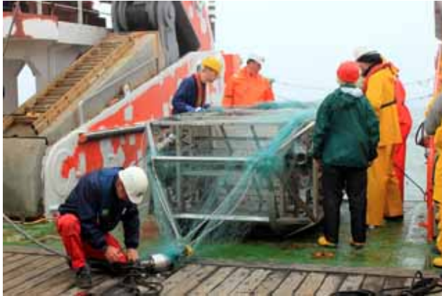
Foto 5: Kamera-Epibenthoschlitten umwickelt mit Fischereinetz. © Anastassya Maiorova
