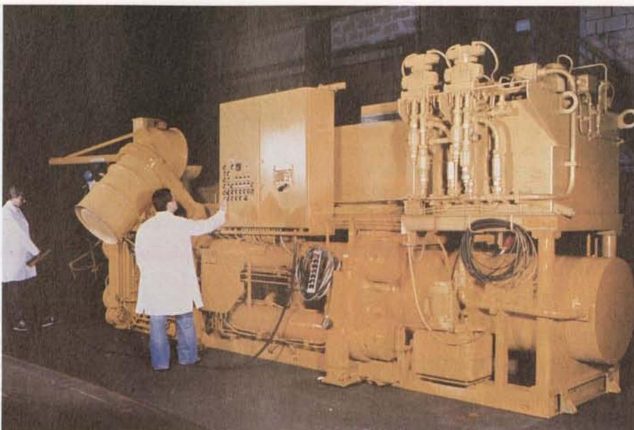
Bild 21: Mobile Hochdruckpresse zur Kompaktierung radioaktiver Abfälle.
