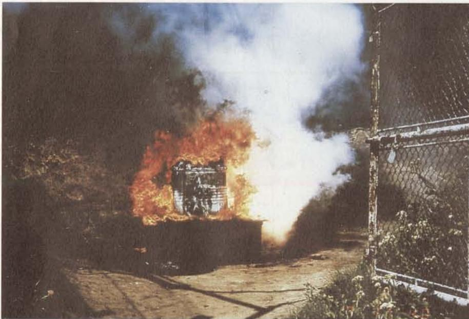
Bild 34: Brandversuch: An inaktiven Simulaten wird untersucht, wie sich Abfallgebilde bei einem Brand verhalten. Die mit den Rauchgasen freigesetzte Materie wird auf Filtern gesammelt und ausgemessen, um festzustellen, wieviel Radioaktivität im Brandfall aus einem Abfallgebilde freigesetzt werden kann.
