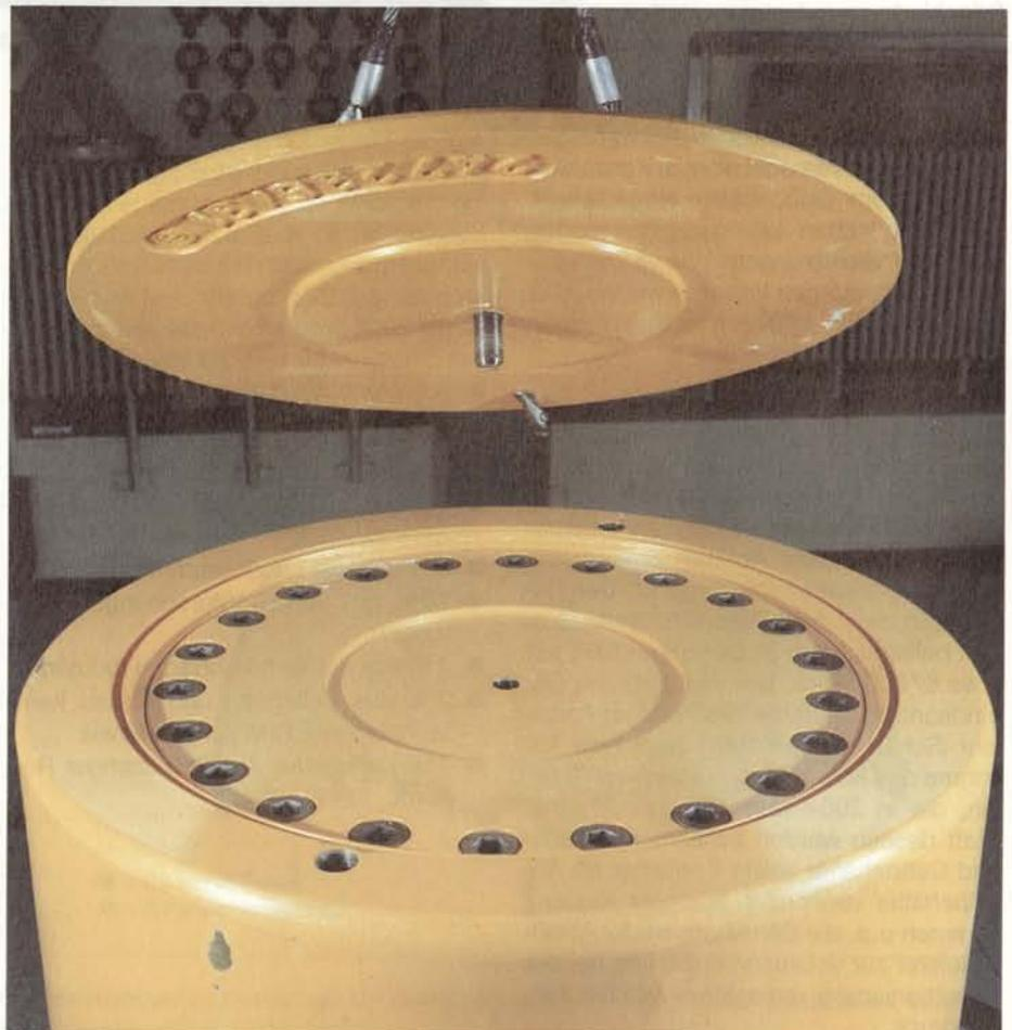
(Bild 23). Sie werden aus Gußwerkstoff (z.B. GGG 40) hergestellt. Die Gußbehältertypen unterscheiden sich hinsichtlich ihrer Abmessungen und Wandstärken sowie der konstruktiven Ausführungen im Deckelbereich. Die Deckel aller Gußbehältertypen werden ebenfalls aus Gußwerkstoff hergestellt und mit dem Behälterkörper verschraubt bzw. verschweißt.
