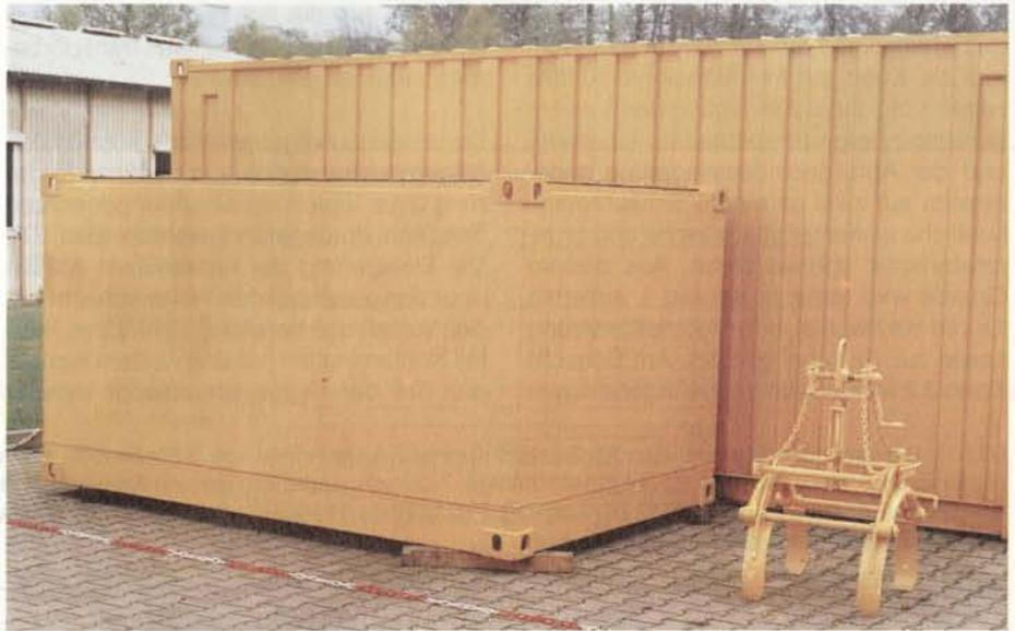
Bild 25: Container Typ V mit Faßgreifer.
