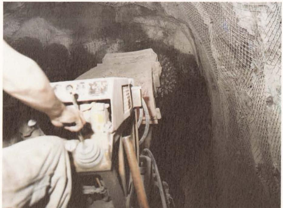
fahrungen mit etwa 25 m<sup>2</sup> Querschnitt wird z. B. das Streckenprofil in einem Arbeitsgang mit etwa 6 m Breite und etwa 4,5 m Höhe geschnitten. Die Ankerbohrlöcher werden mit einer auf der Teilschnittmaschine montierten Ankerbohrlafette abschnittsweise bei Unterbrechung der Schneidarbeiten gebohrt und die Anker gesetzt (Bild 42). Mit großen Teilschnittmaschinen, wie der STM 300, läßt sich ein Querschnitt von 40 m<sup>2</sup> in einem Arbeitsgang auffahren (Bild 43).
