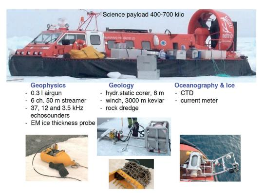
Abb. 1.3: Das Hovercraft Sabvabaa und Auswahl von Geräten für den Einsatz (Foto: Y. Kristoffersen) Fig. 1.3: The hovercraft Sabvabaa and some of its equipment (Photo: Y. Kristoffersen)
