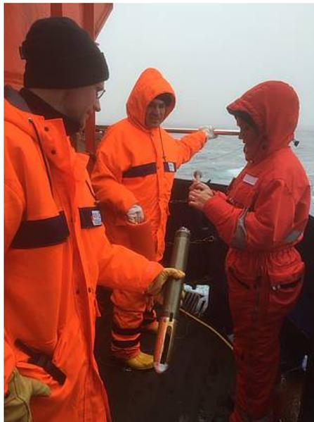
Abb. 6: Die Underway CTD Sonde und ihre Befestigung an die dünne Kevlar-Leine werden während des Transits zu der ersten Verankerungsposition am Heck des Schiffs zwischen Testprofilen inspiziert. Foto: R. Stein/AWI
