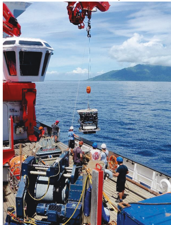
Abbildung 1: Klarmachen von HyBis vor Sakar Island um das OBS zu bergen, das sich an seinem Schwimmseil verfangen hatte. Foto: Oliver Meyer.
