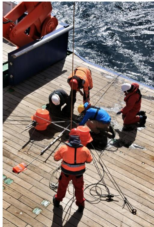
*Die Kopfboje der Verankerung BM-24/3 wird geborgen und anschließend demontiert.*
