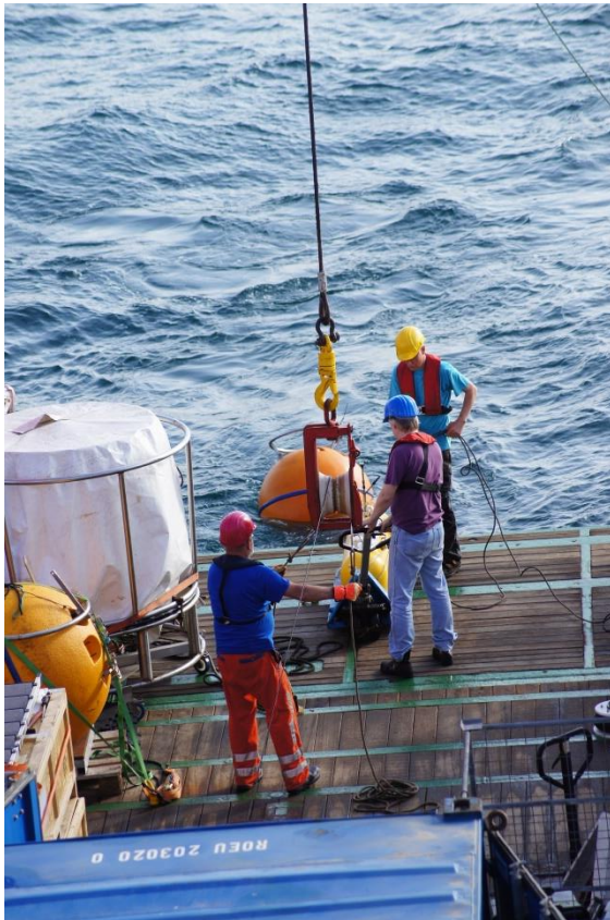
Aussetzen einer Verankerung mit einer am Draht profilierenden CTD und eines Strömungsmessers (Moored Profiler, Photo: M. Dengler).
