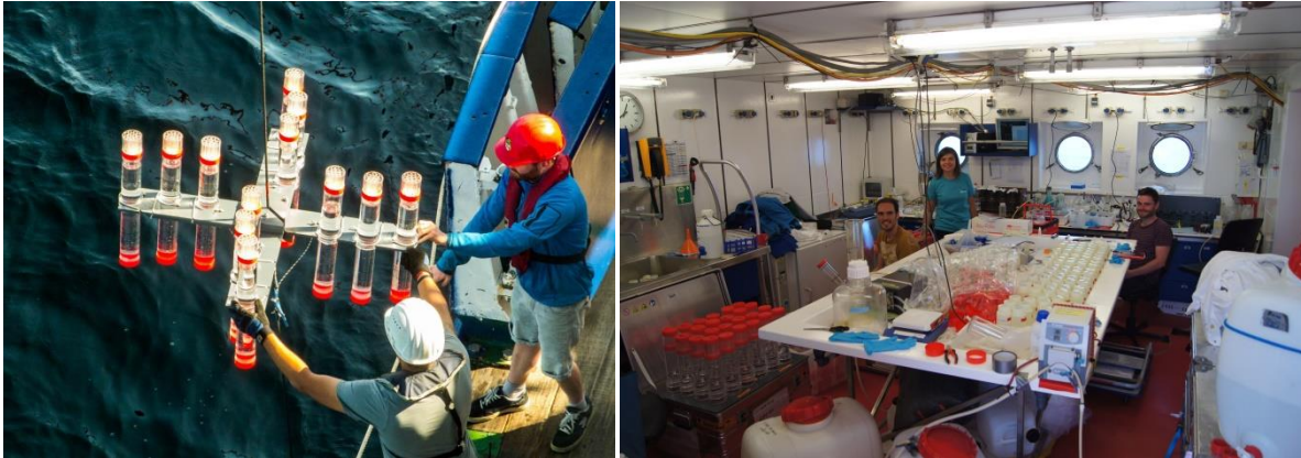
Links: Aussetzen einer treibenden Sedimentfalle. Absinkendes organisches Material wird in den in verschiedenen Tiefen angebrachten Zylindern gefangen und konserviert (Photo: J.F. Schubert). Rechts: Frederic, Carolina und Jon bei der Vorbereitung einer Sedimentfalle (Photo: M. Dengler).
