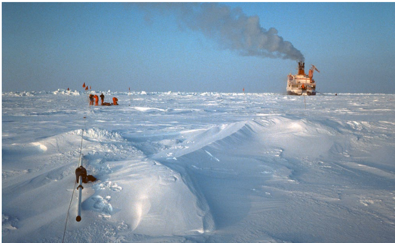
Abb. 1: Messungen mit einem Geonics EM31 auf mehrjährigem Meereis in der Arktis (Framstraße) während einer „Polarstern“-Expedition im Februar/März 1993 (Foto: S. Gerland)
