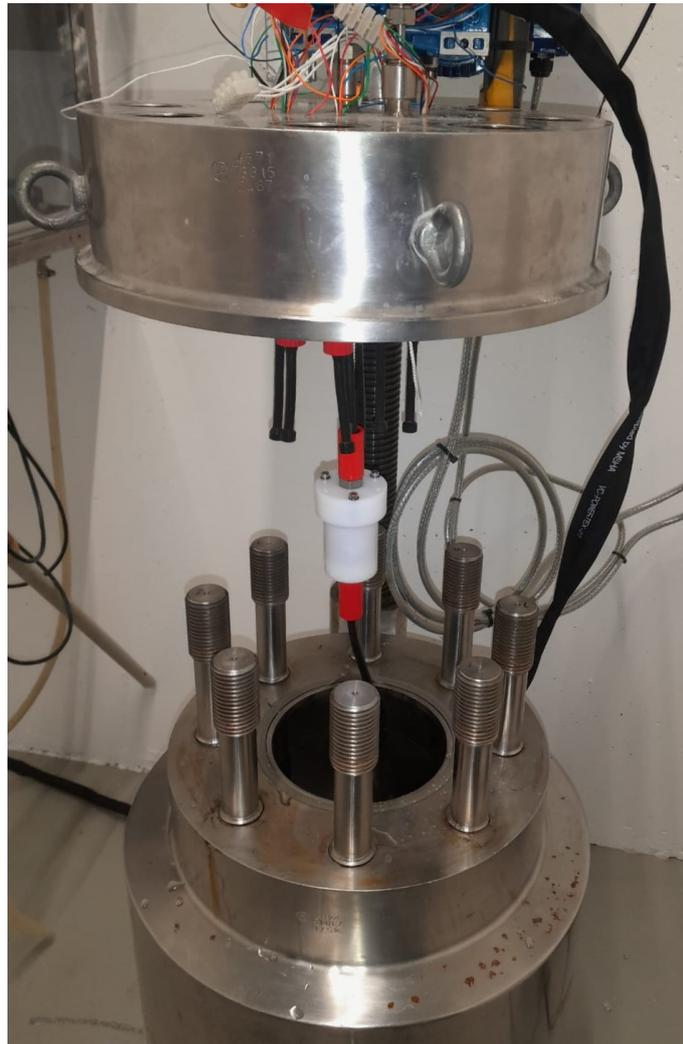
**Abbildung 19:** Offener Drucktank mit Mikrocontroller-Testgehäuse
