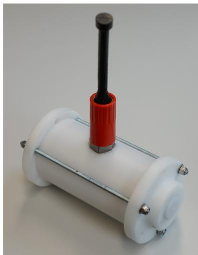
**Abbildung 16:** Fertig montiertes Sensor-Testgehäuse für Drucktest
