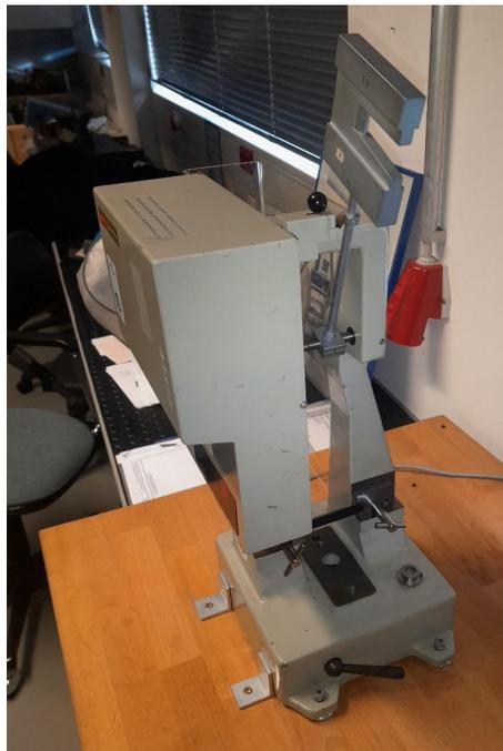
**Abbildung 30:** Versuchsaufbau des Kerbschlagbiegeversuchs mit eingelegter ABS-Probe
