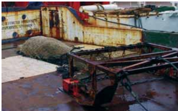
Rastra de fondo (red Agassiz) utilizada en la plataforma continental antártica para tomar muestras científicas (abajo derecha). La bolsa en segundo plano es el final o copo de la red que contiene la muestra luego de un lance, a bordo del rompehielos Polarstern .
