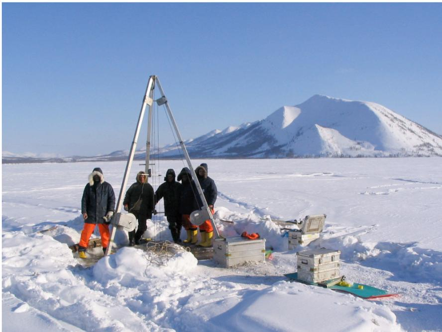
Abb. 1.: Sedimentbeprobung am Billjach-See im Werchojansker Gebirge, Ostsibirien, während der Frühjahrs-Expedition 2005. Die Sedimentkernentnahme aus 18 m Wassertiefe erfolgte über ein dreibeingestütztes Kolbenlotsystem vom 1.5 m dicken Seeeis aus (Foto: Bernhard Diekmann, AWI Potsdam).
