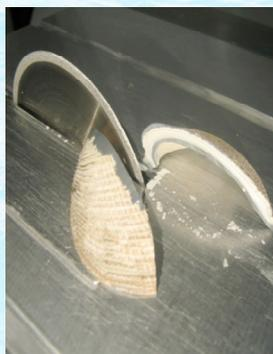
Abb. 3 Schnitt einer Schale von *Protothaca thaca* mittels Diamantsäge
