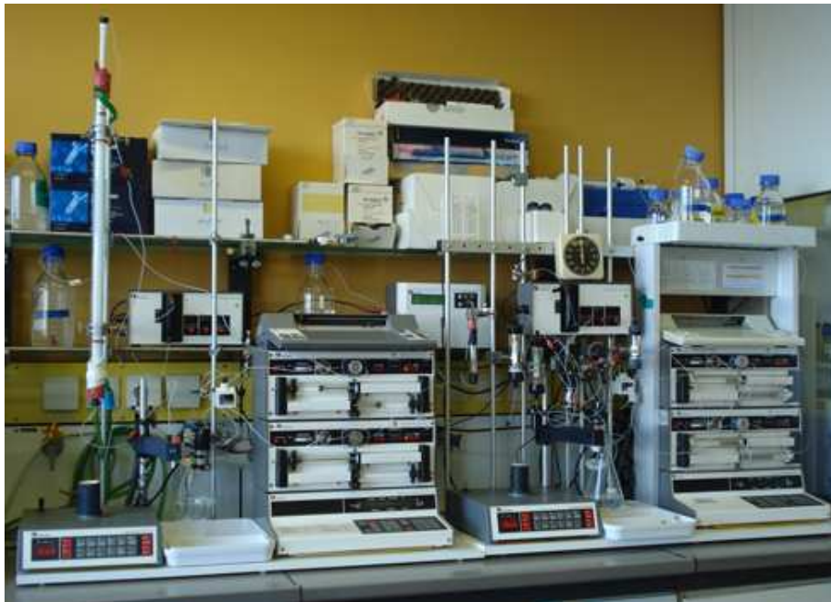
Abb. 2.4 FPLC Systeme zur chromatografischen Auftrennung von Proteinen
