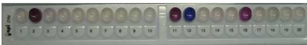
Abb. 3.20: ApiZym Teststreifen mit farblicher, deutlich erkennbarer Substratumsetzung
