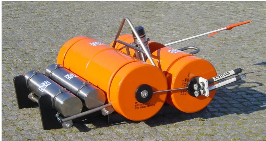
**Abbildung 4:** Der LOBSTER, Longterm BB-OBS for Tsunami and Earthquake Research
