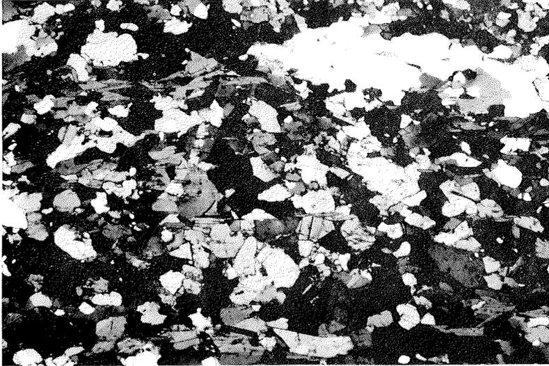
**Abb. II.-21:** Mylonitischer Augengneis aus der steilstehenden Scherzone westlich des *Wrightamaren* (J 25.1./9 // L). Plagioklas ist grobkörnig rekristallisiert und zeigt Erholungsgefüge. Die Korngrenzen sind gerade und weisen  $120^\circ$ -Tripelpunkte auf; untere Bildkante: ca. 4 mm.
