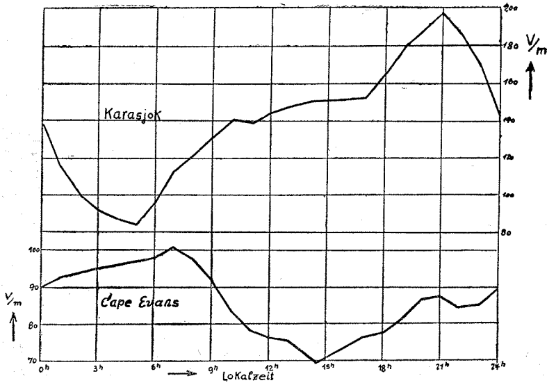
Oben: Mittlerer Tagesgang des luftelektrischen Potentialgefälles an ungestörten Tagen in Prozentual-Darstellung in Karasjok/Lapland nach G. C. Simpson (2), aufgetragen nach Ortszeit. Unten: Das gleiche für Kap Evans nach G. C. Simpson (3).
