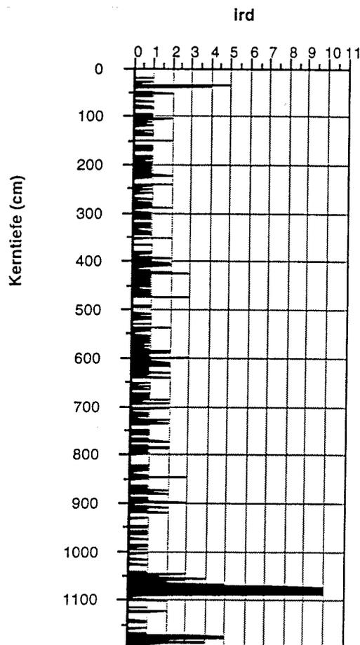
Abb. 21: IRD-Verteilung gegen Tiefe. Der Kiesgehalt wurde in Horizonten von 1 cm Breite ausgezählt und gegen die Tiefe mit Linien entsprechend der Körneranzahl ( $> 2 \text{ mm}/10 \text{ cm}^3$ ) aufgetragen.
