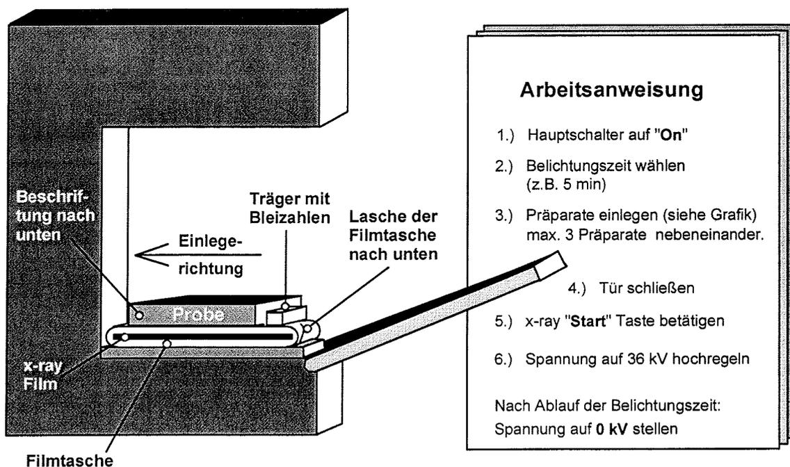
Abb. 9: Röntengerät mit Arbeitsanweisung zur Herstellung von Radiographien
