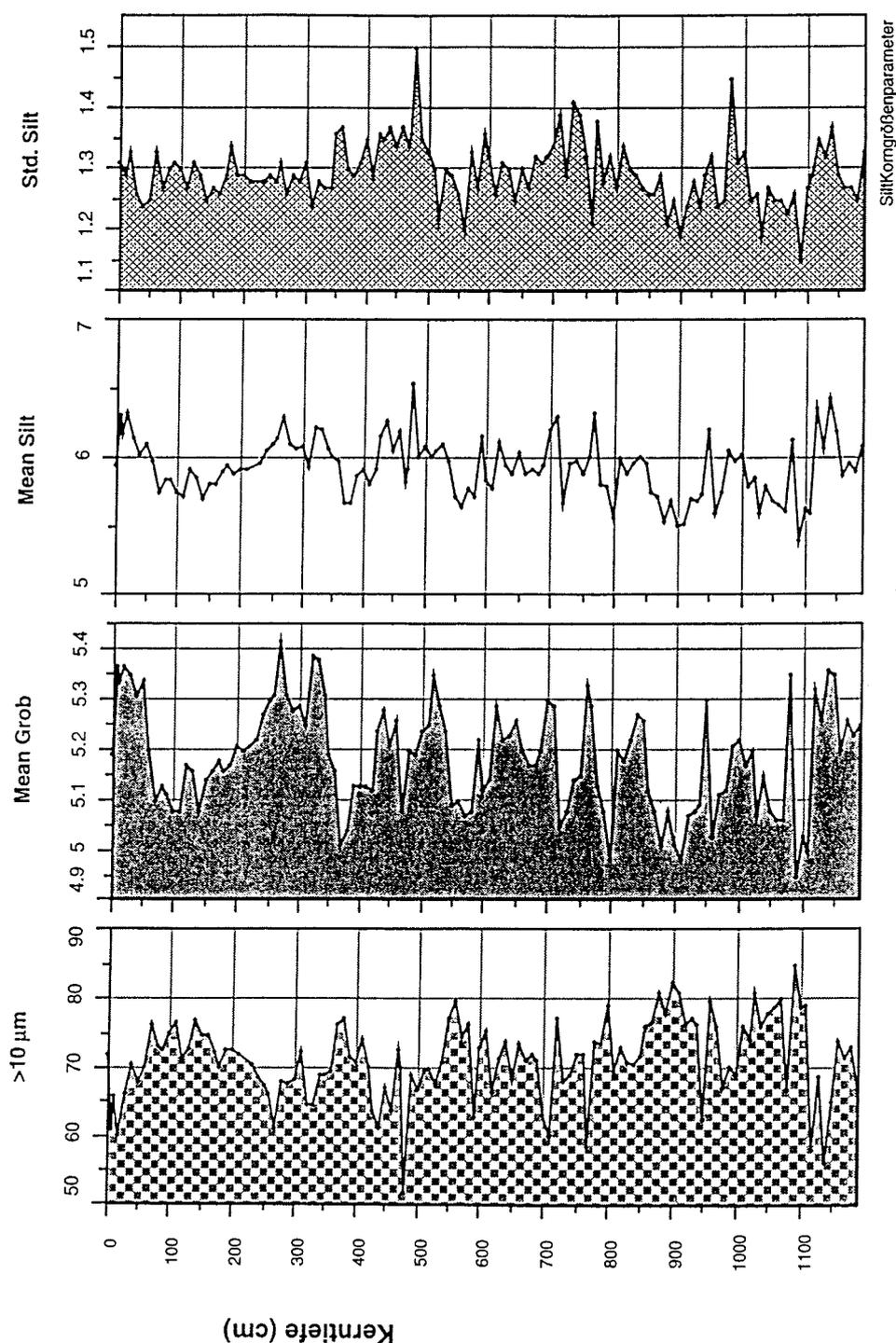
Abb. 25: Statistische Siltkorngrößenparameter des Kerns PS2513-3
