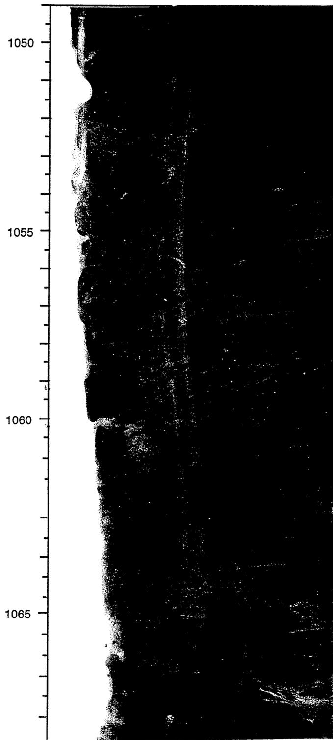
Abb. 17: Radiographie der Sedimentstrukturen in dem Kernabschnitt 1049 cm bis 1068 cm.
