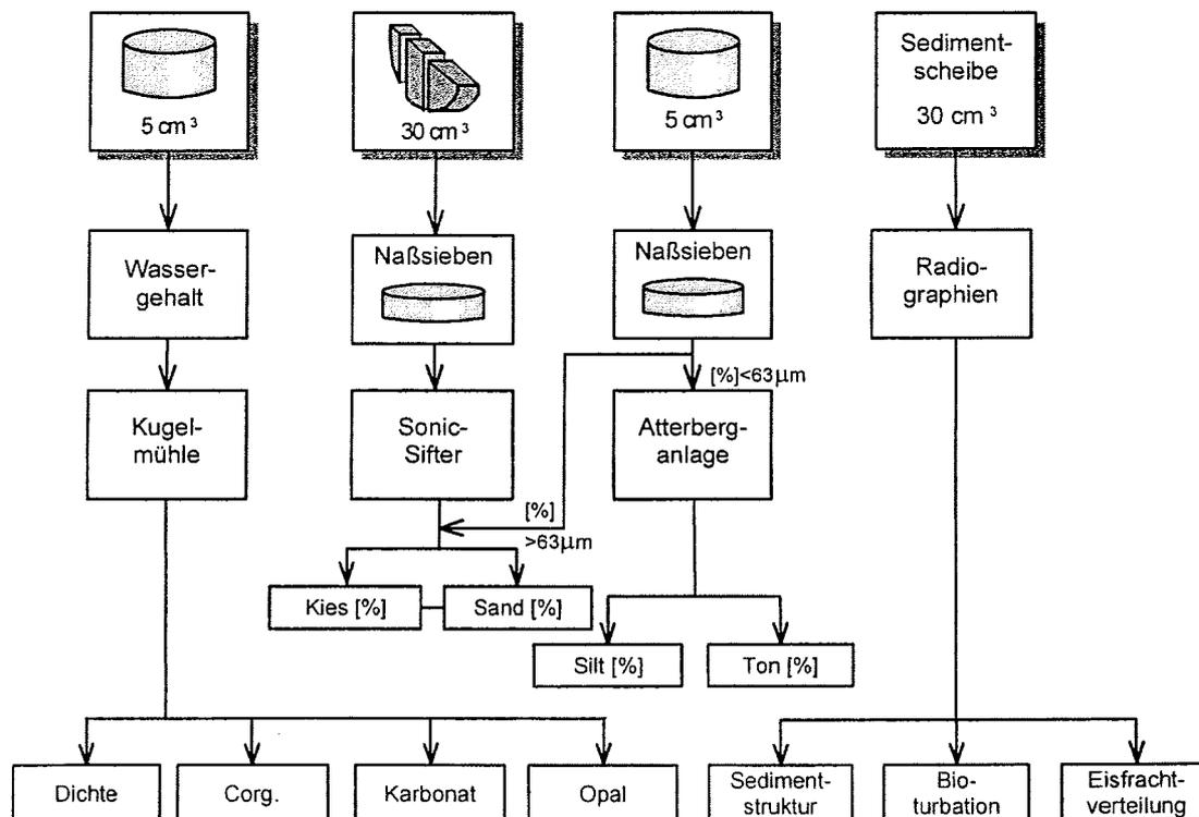
Abb. 8: Flußdiagramm zur sedimentologischen Bearbeitung der Proben
