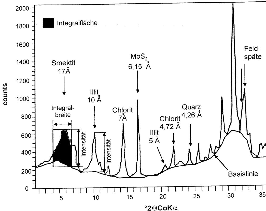
Abb. 15: Das Röntgendiffraktogramm der Probe PS2513-3 in 40 cm Sedimenttiefe zeigt die identifizierten Minerale und deren Peaks. Zur Veranschaulichung der Integralbreite, Integralfläche und der Intensität wurde der Smektit ausgewählt. Die Basislinie markiert die Grenze des Rauschuntergrundes.
