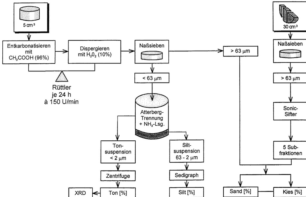
Abb. 14: Flußdiagramm zur Bearbeitung der 5-cm<sup>3</sup>-Probe und der 30-cm<sup>3</sup>-Probe für die anschließende Korngrößenanalyse
