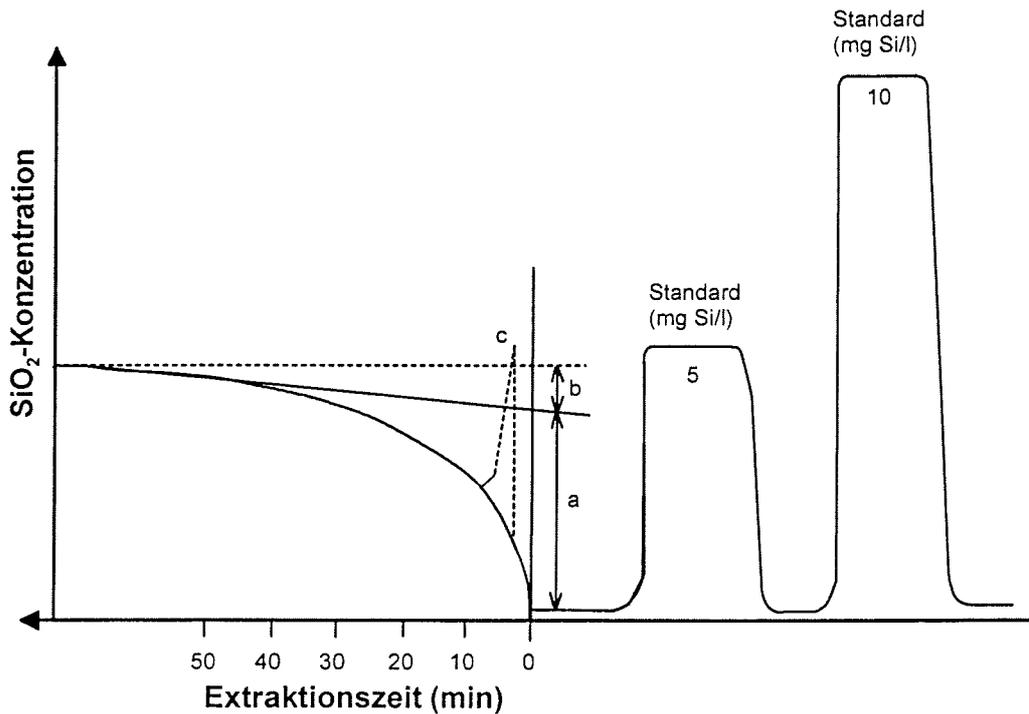
Abb. 13: Schema einer idealisierten Opalkurve nach MÜLLER & SCHNEIDER (1993). a: Extrapolationswert der SiO<sub>2</sub>-Lösung aus biogenem Opal, b: Extrapolationswert der SiO<sub>2</sub>-Lösung aus kristallinen Silikatmineralen, c: sprunghafter Anstieg verursacht durch die plötzliche Lösung von Diatomeen. Die Auswertung erfolgt graphisch durch das Ablesen der Skalenteile
