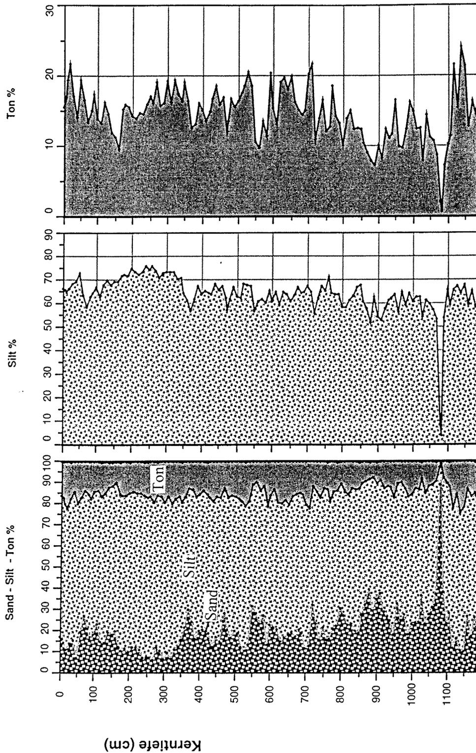
Abb. 23: Korngrößenverteilung im Sedimentkern PS2513-3
