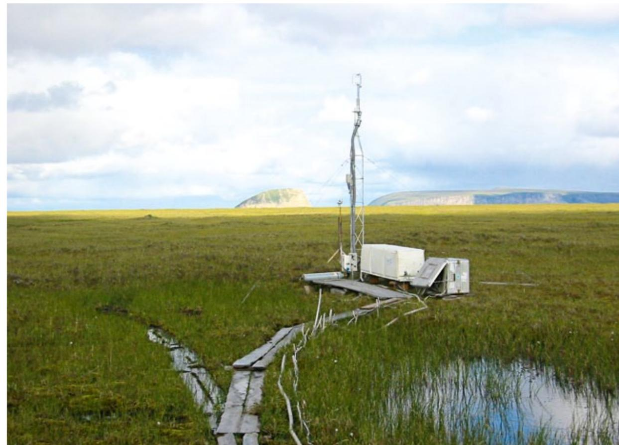
**Abb. 1: Eddy-Kovarianz Messsystem zur Bestimmung der vertikalen CO<sub>2</sub> und Methanflüsse zwischen Boden und Atmosphäre.**
