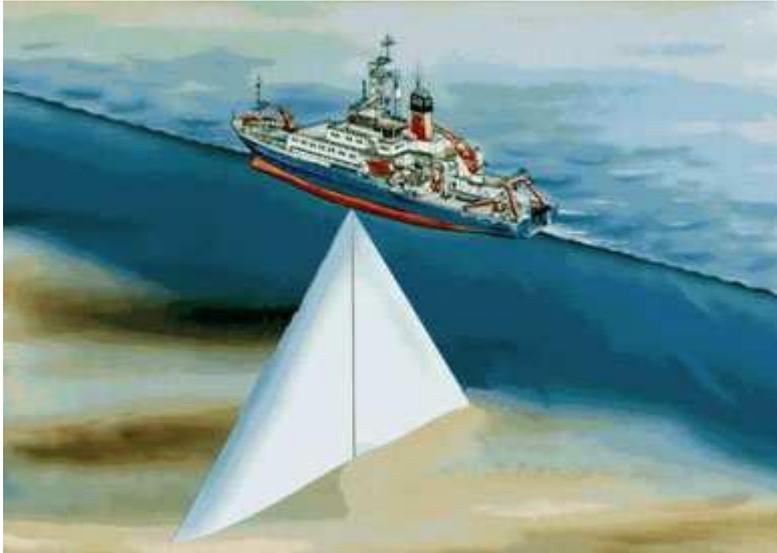
**Abb. 3.1:** Hydrosweep DS Fächerecholot auf FS Meteor analog zu FS Polarstern (ACT, 2011).
