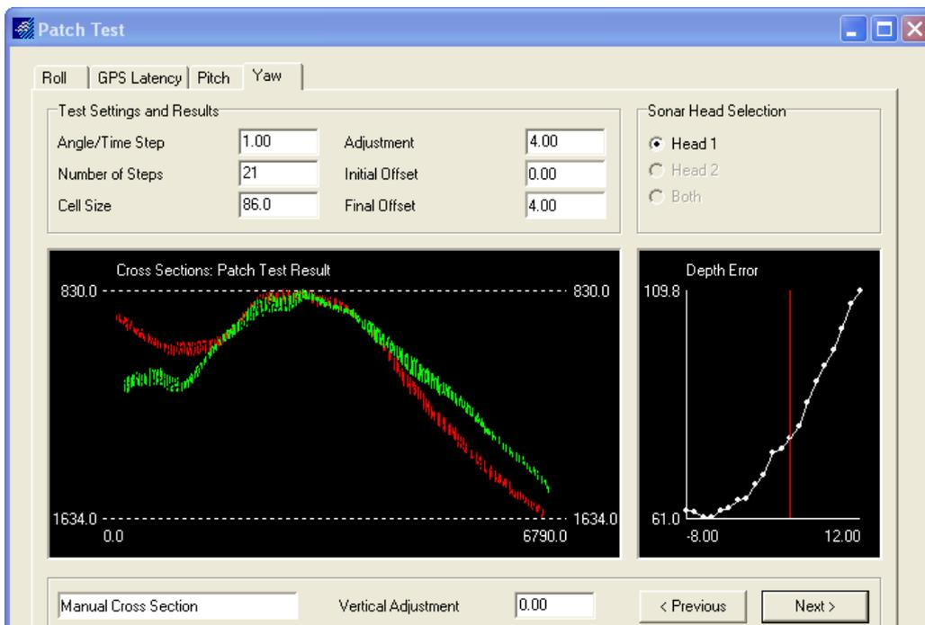
**Abb. II.6:** Aufgrund der geringen Übereinstimmungen der Daten, durch den 900 m-Versatz, kann die Heading-Kalibrierung, für MINS 1 sowie MINS 2, nicht durchgeführt werden.
