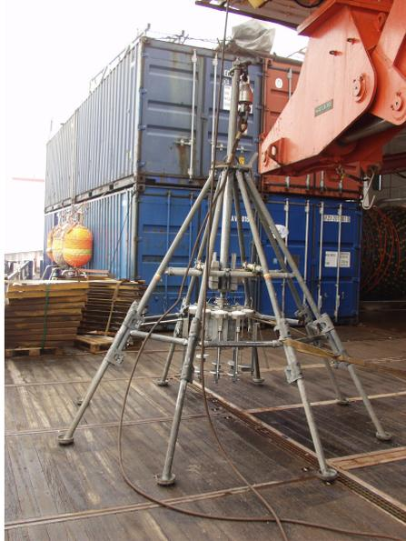
**Abbildung 6.3:** Multicorer an Deck des Forschungsschiffes Polarstern
