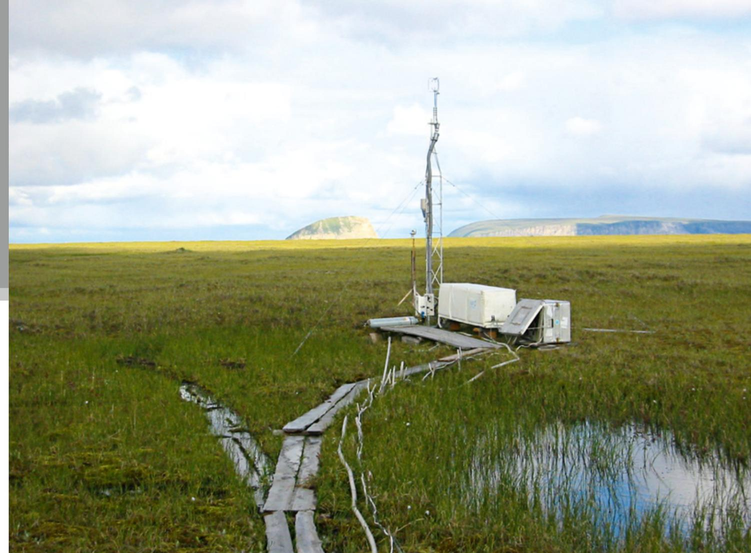
Abb. 3.3: Beobachtungssystem für zeitlich hochaufgelöste Messungen im Lenadelta der Spurengasflüsse zwischen sibirischer Tundra und Atmosphäre. (Foto: Torsten Sachs)
