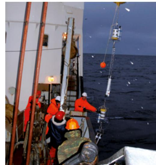
Abb. 3.2: Ausbringung einer Verankerung in der Laptewsee. Die Instrumente registrieren über ein Jahr die Veränderung der Strömung sowie der Wassertemperatur und des Salzgehalts infolge von Meereisbildung und Flusswassereinstrom aus der Lena. (Foto: Heidi Kassens)
