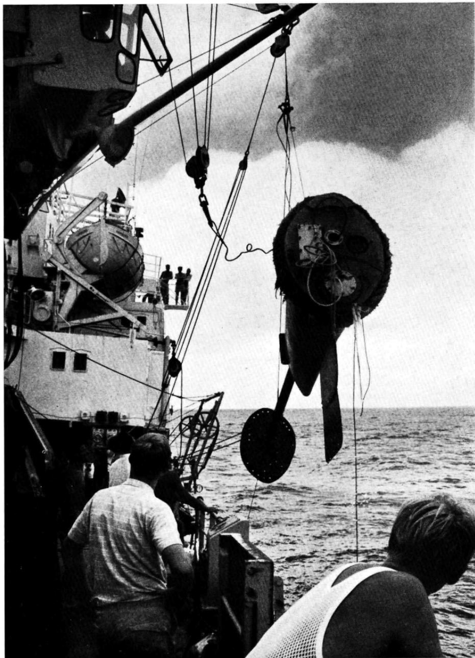
Bild 3: Schweres Gerät – hier die 1,8 t wiegende meteorologische Boje – wird mit Baum und Kran auf das Arbeitsdeck gehievt
