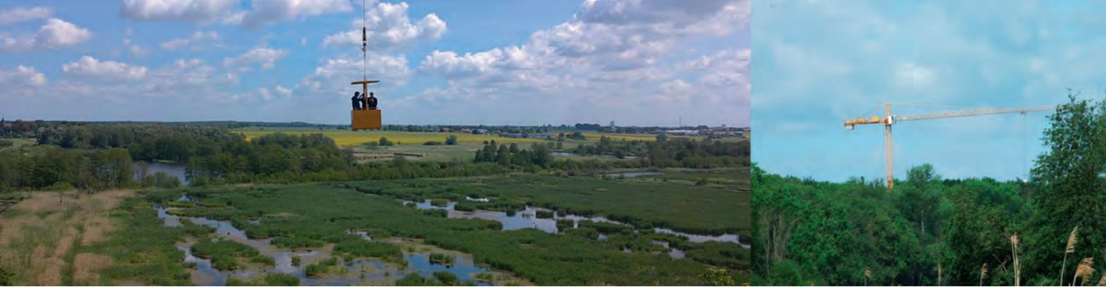
Abb. 4.3: Im TERENO Observatorium „Norddeutsches Tiefland“ (Koordination: GFZ) wird die Beprobung von schwer zugänglichen Feuchtgebieten und Baumkronen durch Krananlagen ermöglicht. (Fotos: Markus Reich, GFZ)
