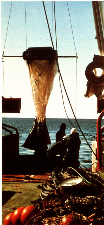
links oben: Ein Mehrfach-Schließnetz (RMT 8 + 1/M) zum Fang von Zooplankton und Mikronekton (Plötz)
