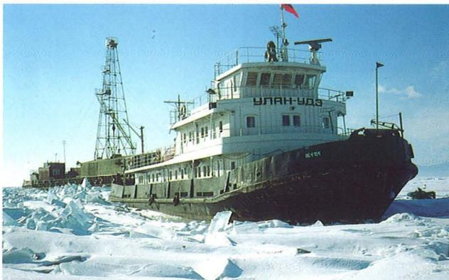
Abb.1: Bohrlokation BDP-96 im Baikalsee im Gebiet des Akademiker-Rückens. Bohrplattform und Versorgungsschiff im Einsatz für das internationale Baikalsee-Bohrprojekt (BDP). Die Tiefbohrungen werden in den Wintermonaten mit einem speziell dafür ausgerüsteten Bohrschiff niedergebracht, welches an der Bohrstelle im Eis eingefroren wird (Foto: Oberhänsli).
