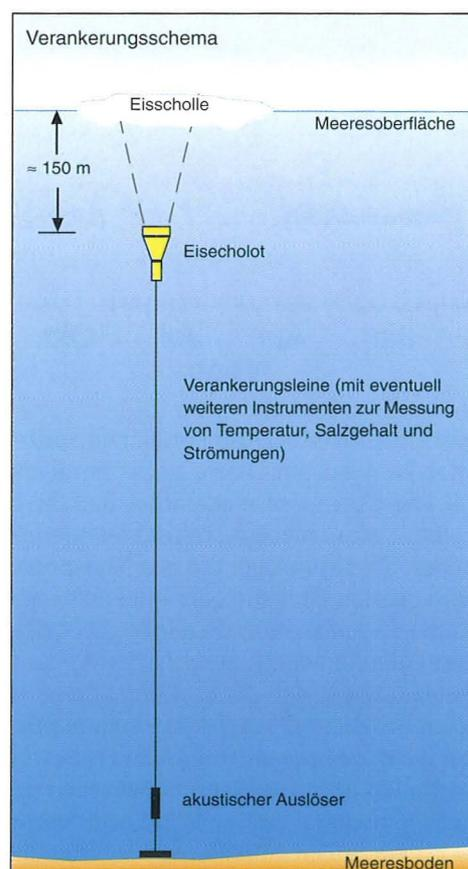
Eisecholote ermöglichen es, die wechselnde Dicke des Meereises das ganze Jahr über zu messen: Die verankerten Eisecholote (Abb. 1) zeichnen bis zu zwei Jahre lang auf, wie sich die Eisdicke an einer Position verändert. Bisher konnte die Dicke des Meereises nur mit Bohrungen bestimmt werden. Das war außerdem nur im Polarsommer möglich, da die Polarmeere im Winter weitgehend unzugänglich sind.
