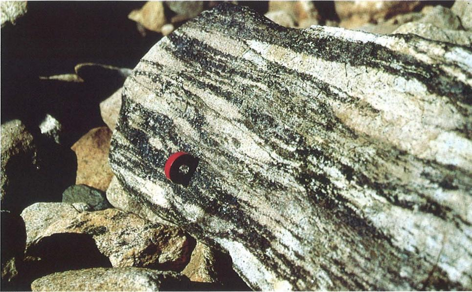
Abb. 4: Messung der magnetischen Suszeptibilität an Gesteinen in Ostgrönland. Dieses Gestein enthält große Mengen des Minerals Magnetit (dunkle Streifen). Ein Taschenmagnet bleibt daran haften. (Foto: Schlindwein)
